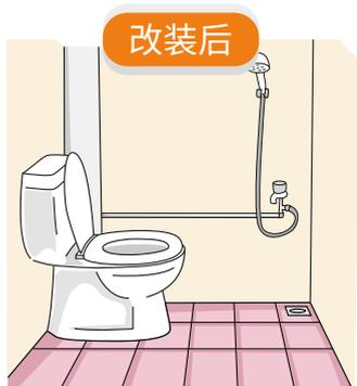
用水泥将下凹的淋浴区填平至与厕所地面相同的高度
